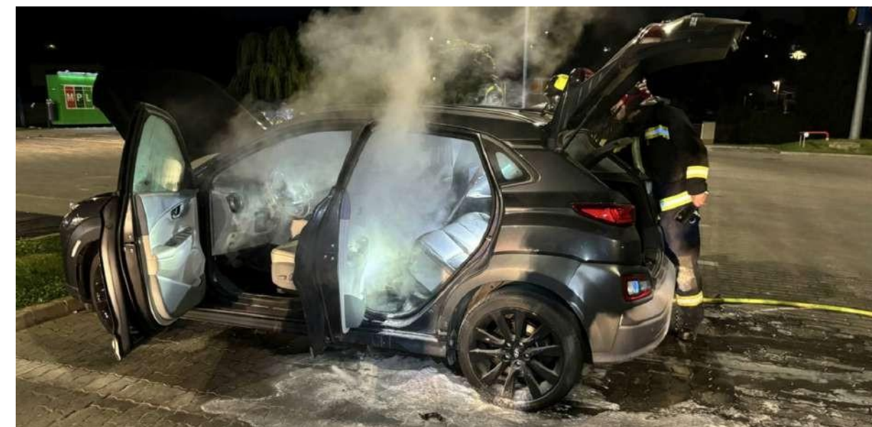
Vaporii albi emiși de un vehicul electric indică o baterie defectă – Sursa: infostart.hu
