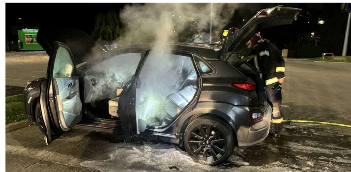
Il fumo bianco proveniente da un veicolo elettrico indica una batteria danneggiata – Fonte: infostart.hu
