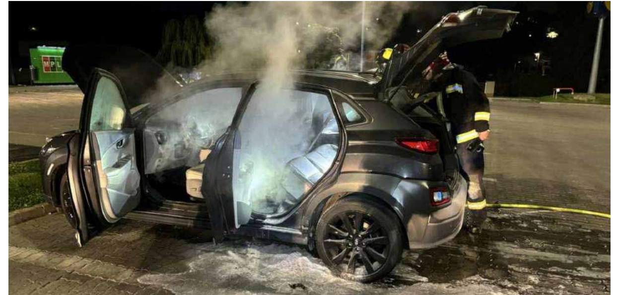
Das weiß rauchende Elektrofahrzeug deutet auf eine beschädigte Batterie hin Quelle: infostart.hu
